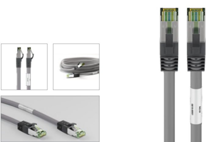
Goobay CAT-8.1-Patchkabel, S/FTP (PiMF) 99,9 % sauerstofffreier Kupferleiter (OFC), AWG 24, halogenfreier Kabelmantel (LSZH)
