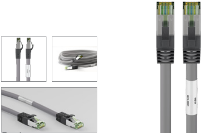
Goobay RJ45 (CAT 6A, 500 MHz) Patchkabel mit CAT-8.1 S/FTP-Rohkabel 99,9 % sauerstofffreier Kupferleiter (OFC), AWG 24, halogenfreier Kabelmantel (LSZH)
